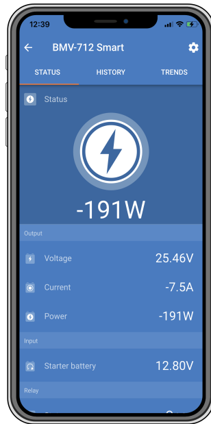
Pantalla de estado de la aplicación VictronConnect de un monitor de baterías funcionando en modo monitor CC.
